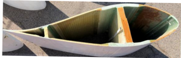
Fig. 11 - Typische doorsnede en materiaalopbouw - 2 lijven (links) en 1 lijf (rechts)
